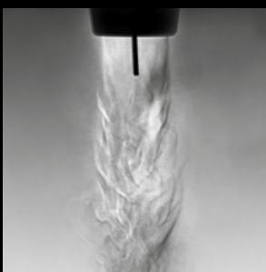
Поток защитного газа оказывает сильное влияние на качество сварного шва. Как правило, защитный газ невидим, однако шлирен-метод визуализации позволяет наблюдать реальное движение газа. Это подтверждает, что благодаря конструкции сварочной горелки Flexlite GX и используемым расходным материалам создается ламинарный поток газа и повышается эффективность его воздействия.
