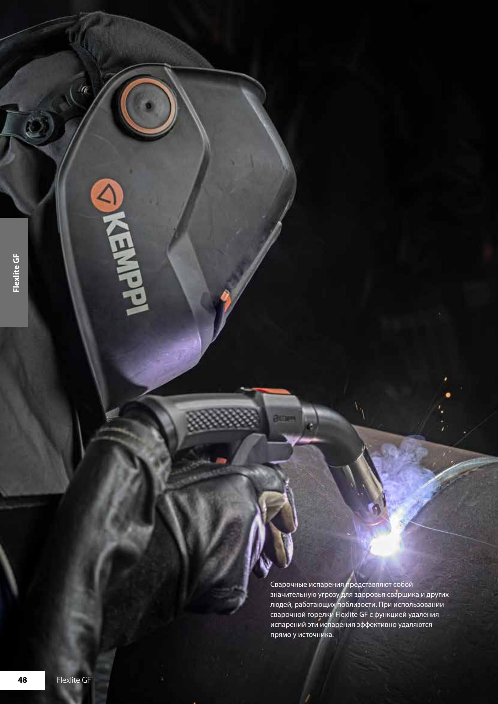
Сварочные испарения представляют собой значительную угрозу для здоровья сварщика и других людей, работающих поблизости. При использовании сварочной горелки Flexlite GF с функцией удаления испарений эти испарения эффективно удаляются прямо у источника.
