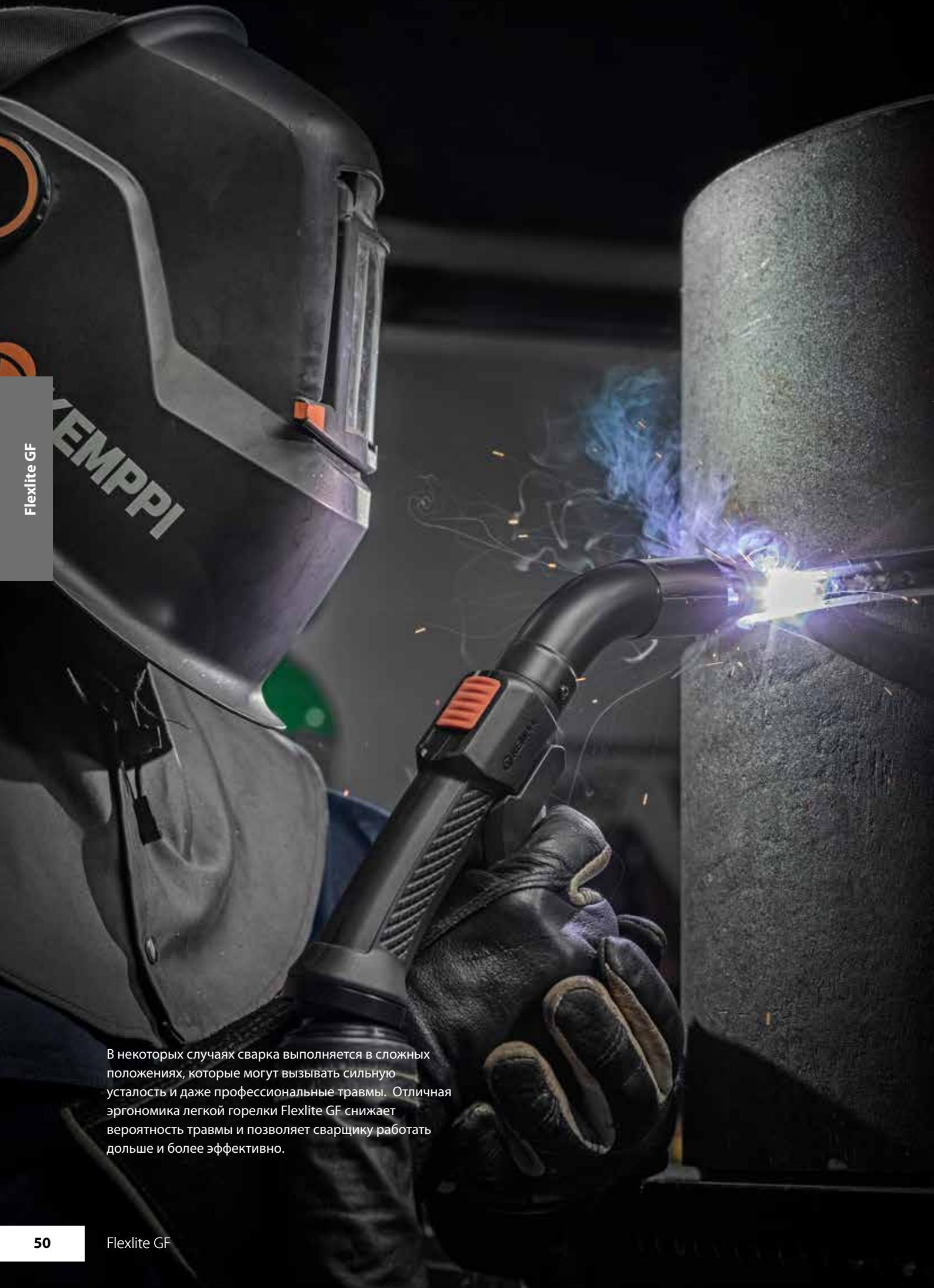
В некоторых случаях сварка выполняется в сложных положениях, которые могут вызывать сильную усталость и даже профессиональные травмы. Отличная эргономика легкой горелки Flexlite GF снижает вероятность травмы и позволяет сварщику работать дольше и более эффективно.
