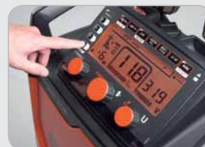
*Модели Kemppac Adaptive (A) предлагают специальные функции, в том числе возможность установки мощности в зависимости от толщины листа, выбор присадочного материала и каналы памяти.*
